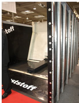
Foto 2 Doseringscontainer i kunststof og bevægelig bagplade
